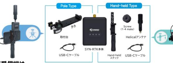
GNSS RTK測位ソリューションを搭載したSynRTK受信機は Androidの携帯電話およびUSB 3.0及びBluetoothによって2-3cm高い精度の位置情報を提供します。
